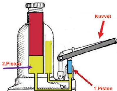
Hidrolik kriko sıvıların üzerine uygulanan basıncı her yöne iletmesi ilkesinden yararlanılarak çalışmaktadır. Yani sıvı üzerine uygulanan basınç sıvı içinde her yöne aynen ilettilir. Bu basınç kullanılan sıvının cinsine bağlı değildir. Bu yüzden 1. ve 2. bilgiler yanlıştır. **Cevap C olmalıdır.**
