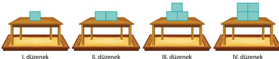
Düzeneklerde masaların ayaklarının yere temas eden yüzey alanları değişmezken masa üzerindeki küp sayısı zamanla artmaktadır. Masanın basıncı artacağı için bu nedenle masanın ayaklarının zemine batma miktarı zamanla artmalıdır. Bu duruma en uygun çizilen grafik A seçeneğinde verilmiştir. **Yani cevap A olmalıdır.**
